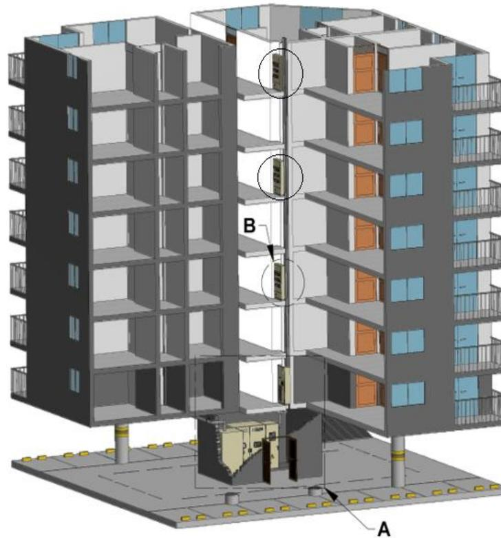
**Figura 2A. Detalle A de la Figura 2, Tablero General de Alimentadores (TGA).**
